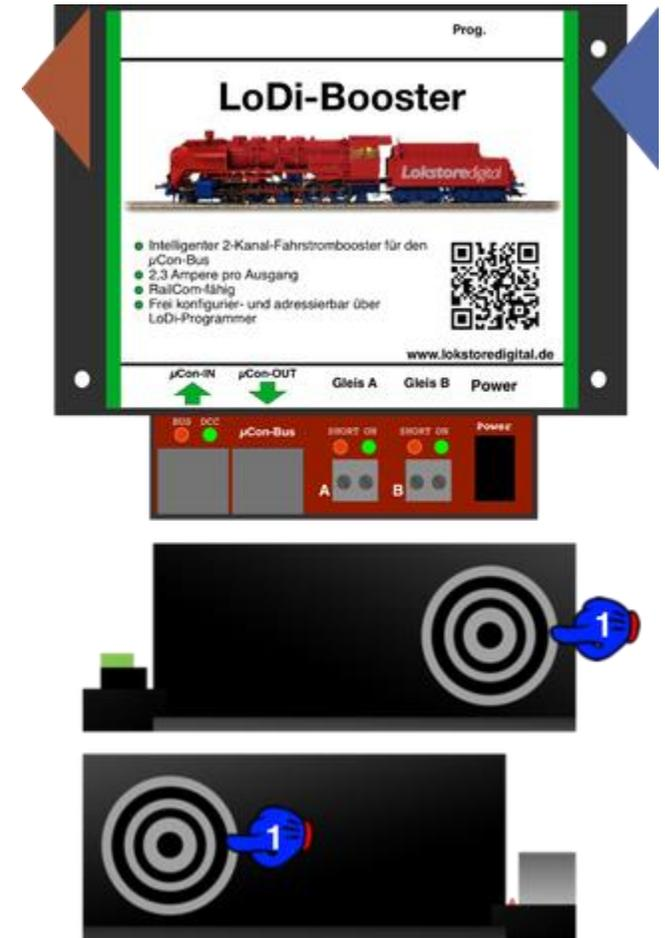
Die Luft wird von rechts nach links durch das Gerät gedrückt
